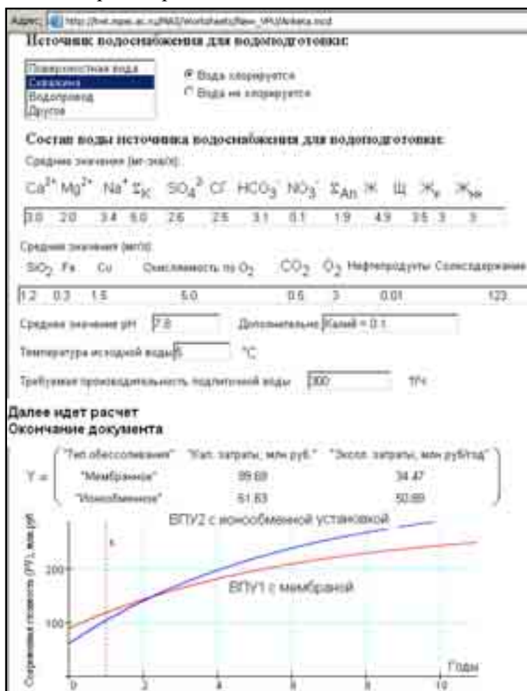
Рис. 7. Пример оценки в Интернете технико-экономических параметров реконструкции химцеха электростанции ( http://twt.mpei.ac.ru/MAS/Worksheets/New_VPU/Anketa.mcd )
