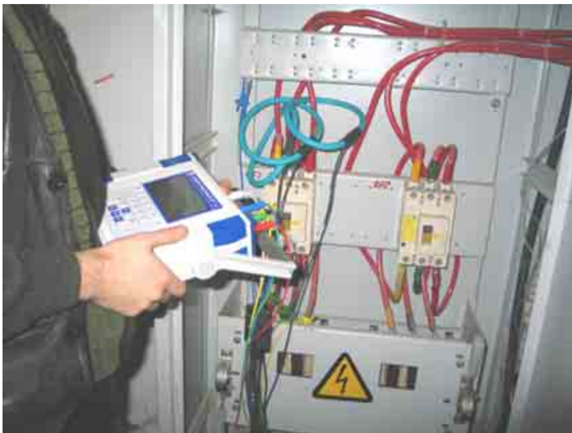
Рис. 8. Прибор «Энергомонитор 3.3» с гибкими датчиками тока
